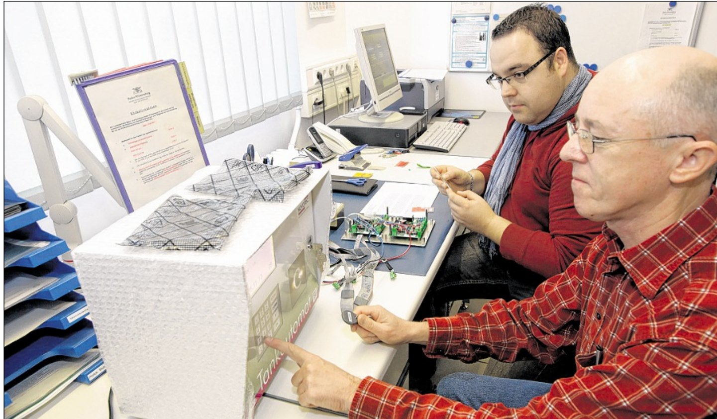
DAS INNENLEBEN EINES TANKAUTOMATEN überprüft Eichamt-Mitarbeiter Mario Frean Chapero (hinten). Rund 30 Minuten dauert die Prüfung. Vorne im Bild Jürgen Seufert von der Karlsruher Firma Novotec, die die Geräte herstellt. Foto: jodo
