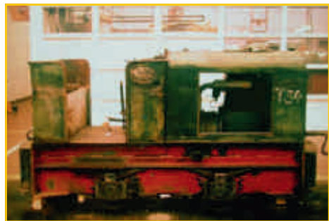
Das war die Grundlage, auf der die Verkehrsbetriebe Karlsruhe eine neue Lok aufbauten. Eine offene Feldbahnlokomotive von Gmeinder, Typ C60, die früher in Nußloch bei einer Ziegelei fuhr.
