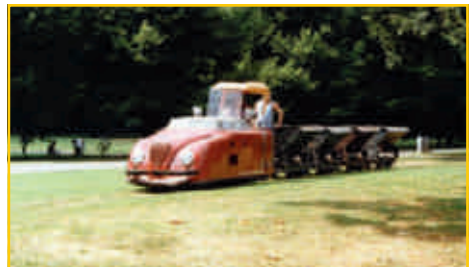
Die Porschelok im Arbeitszeugeinsatz. Die Loren stammen von verschiedenen stillgelegten Feldbahnen und haben im Schlossgarten eine neue Heimat gefunden. Aufnahme: Sammlung M. Müller.
